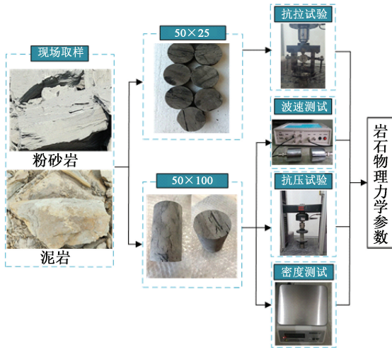
图1 岩石物理力学参数的测试流程(单位: mm)
