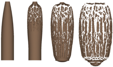
图 3 钢套管装药的三维破片过程
