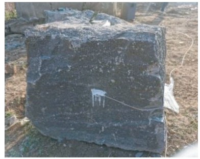
图 3 PVDF 薄膜传感器粘贴效果
