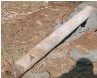
图 15 试验后的套管
