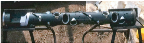
图 9 新型震源弹装配图
