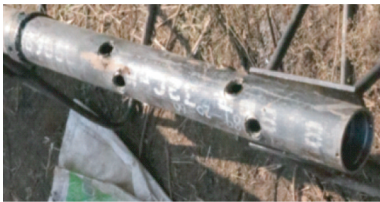
图 14 试验后的 89 型震源枪
