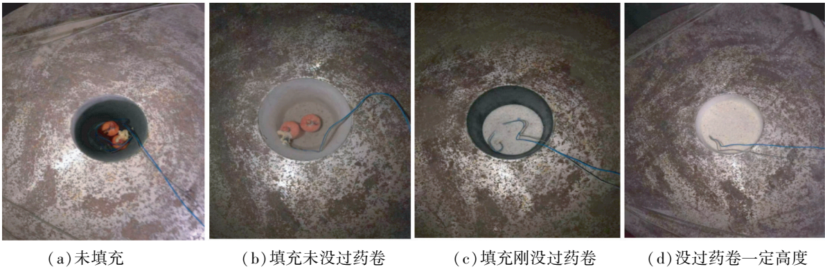
图 2 不同石英砂填充量时的装药 Fig. 2 Charge with different filling volume of quartz sand
