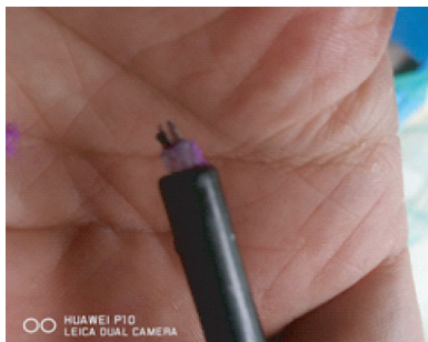
(b) 振后引火药已脱落
