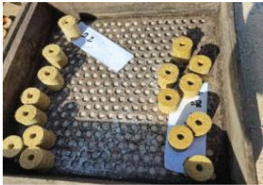
图 2 成型药柱 Fig.2 Shaped grain
