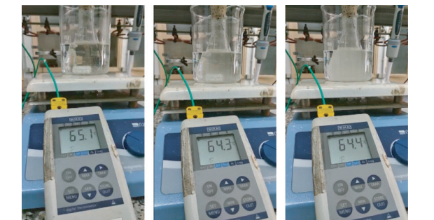
图 2 带水浴实验过程中的温度变化
