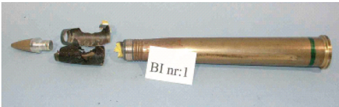
图 11 子弹撞击试验结果 Fig. 11 Results of popping condition test
