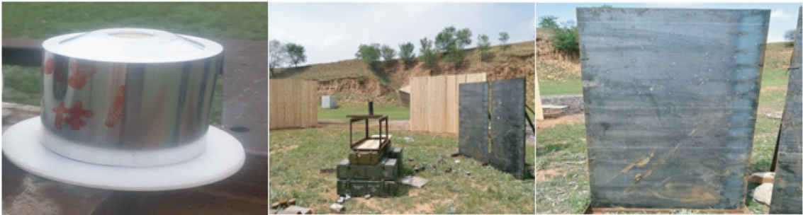
(a) 战斗部实物图 (b) 试验现场 (c) 破片的着靶情况
