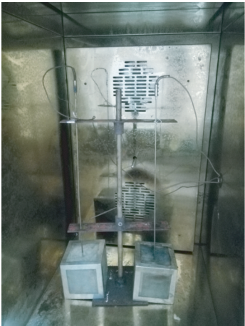
图 1 自燃点测试装置
