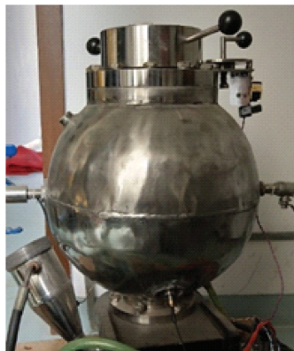
图 1 20 L 球形燃爆装置实物图
