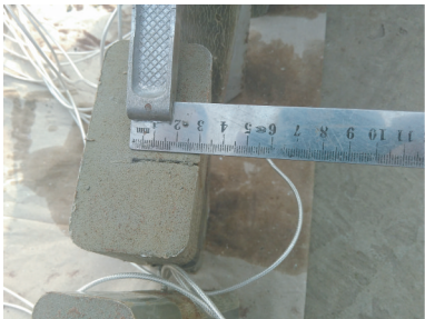
图 2 切割深度测量 Fig. 2 Cutting depth measurement
