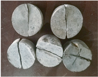
图3 劈裂后试件
