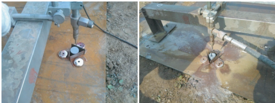
图 2 固定式切割试验 Fig. 2 Fixed cutting test
