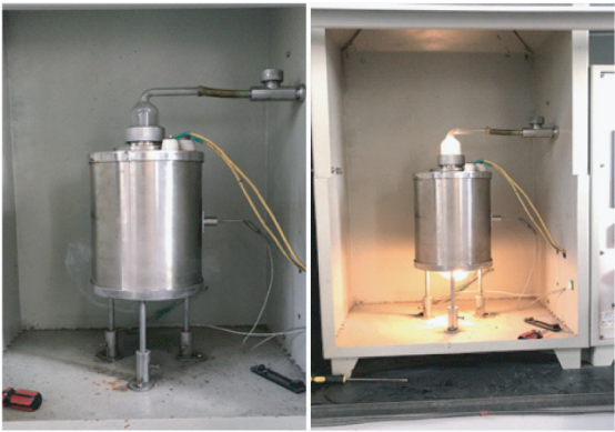
(a)有烟,未着火 (b)有明显火焰,着火 图 9 试验现象
