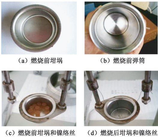
图 6 充氮氧弹法测燃烧残渣
