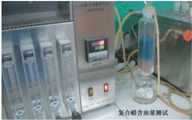
图1 BSY-246 型石油蜡含油量测定仪
