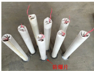
图 4 导爆管粘在防爆片上
