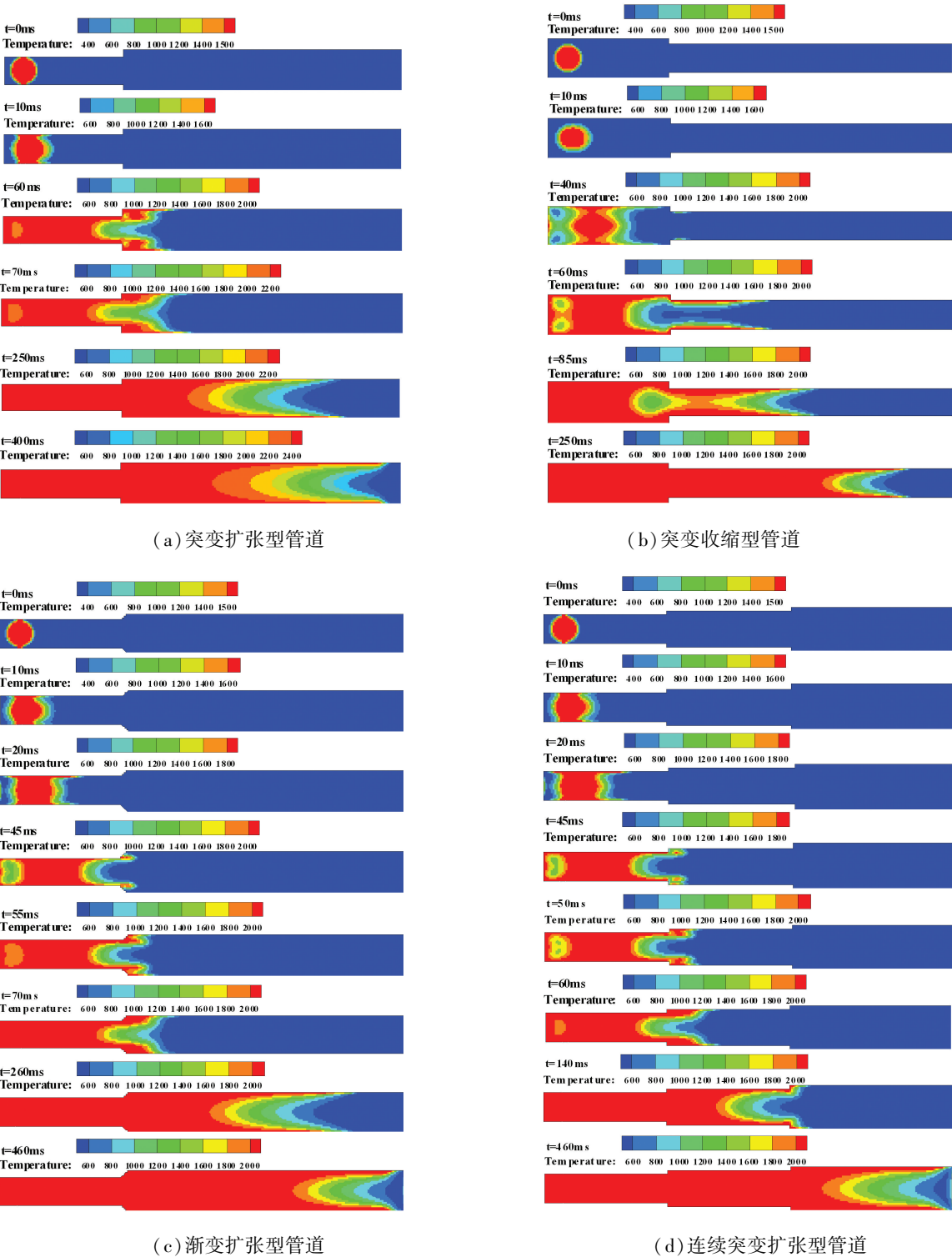
图 2 变截面管道中预混 H_2 /Air 燃烧火焰传播过程(单位:K)
