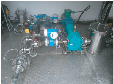
图 3 硬摩擦热升温试验装置
