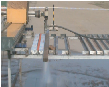
图 2 防暴弹切割实例
