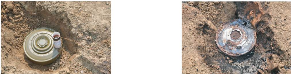
图 4 高能燃烧剂销毁金属地雷 Fig. 4 Metal mine destroyed by termite
