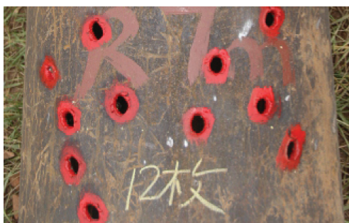
图14 破片对靶筒的穿孔
