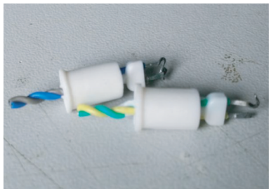
图 5 改进后的电雷管脚线塞
