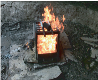
图 6 快烤试验后的试验钢管
