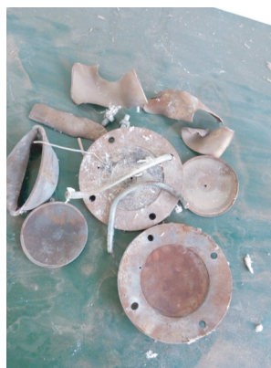
图 10 试验后的样品钢管
