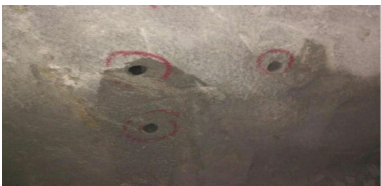
图 4 声波孔现场布置图
