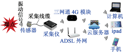
图 9 Blast-Net 型爆破测振系统示意图
