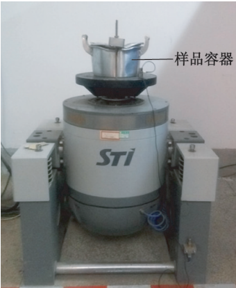
图 2 振动冲击试验装置
