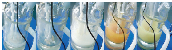
图 4 15℃ 下硝硫混酸加入到悬浮液中及加水水解过程的反应现象
