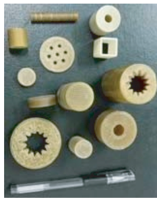
图 7 打印出的复杂结构代料药柱
