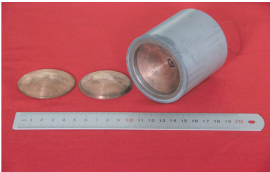
图 7 双层药型罩 EFP 战斗部 Fig. 7 EFP warhead of the double layer liner
