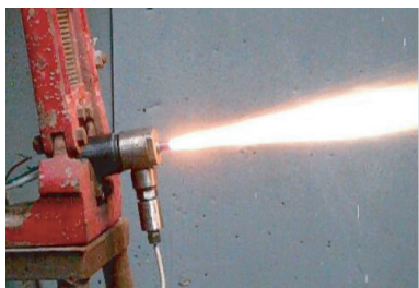
图7 静态发动机试验
