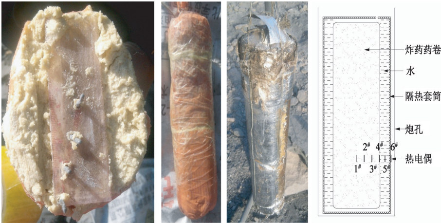
图 1 热电偶相对位置示意图
