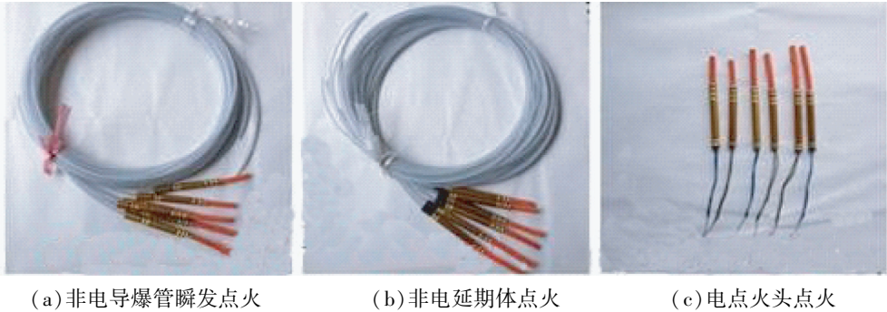
图 2 3 种常规点火方式的组装图
