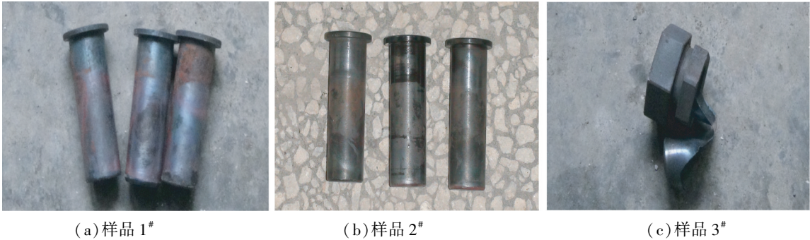
图 5 克南试验结果 Fig.5 Results of Koenen test
