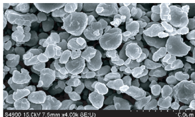
(a) 微米级 \text{KNO}_3 粉体
