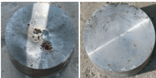
(a)正面 (b)背面 图 7 方案 III 侵彻结果 Fig. 7 Penetration results in scheme III
