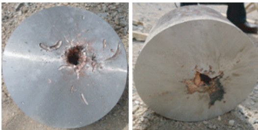
(a)正面 (b)背面 图 6 方案 II 侵彻结果 Fig. 6 Penetration results in scheme II
