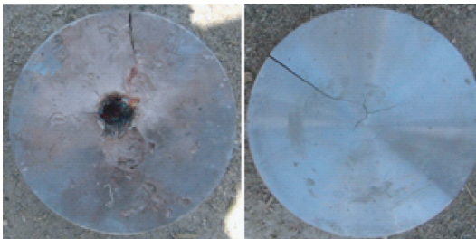
(a)正面 (b)背面 图 5 方案 I 侵彻结果 Fig. 5 Penetration results in scheme I
