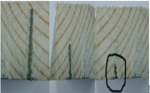
图 7 陶瓷球对松木靶板的穿深
