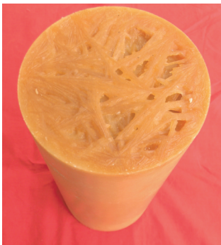
图 10 MCX-D 炸药压滤装药样品
