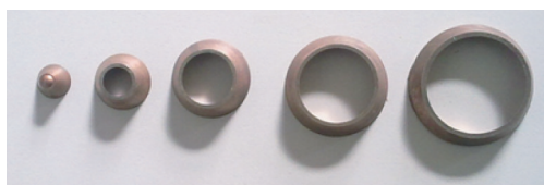
图 2 药型罩环形切割分解图
