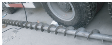
图 7 储存罐底部输送螺旋
