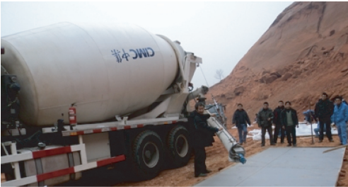
图 6 BCJX 铵油车在现场装药
