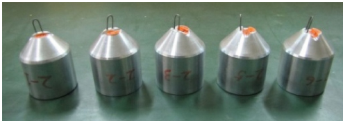
图 3 试验用射孔弹 Fig. 3 Perforating bullet for experiment
