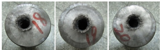
图 8 试验后的 18、19、20 号靶柱
