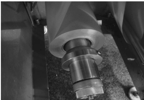
图 2 RH90 热合机挂膜机构
