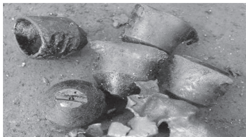
图 2 射孔弹壳体变形情况二
