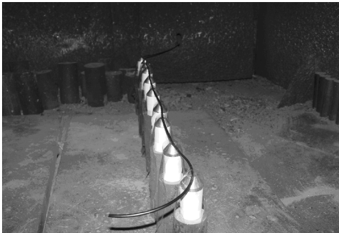
图 6 石油射孔弹侵彻钢靶实验装置
