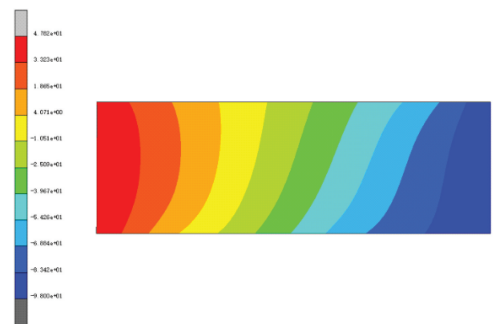
图 12 药柱在 15 MPa 压制力下回弹后的位移云图
