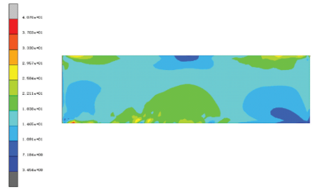
图 7 等效米塞斯应力分布云图
