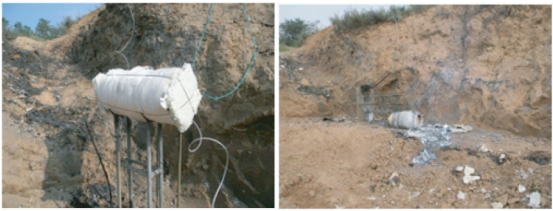
(a) 试验前 (b) 试验后 图 9 慢速烤燃试验
