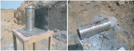
(a) 试验前 (b) 试验后 图 10 子弹撞击试验
