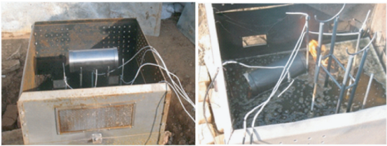
(a) 试验前 (b) 试验后 图 8 快速烤燃试验
