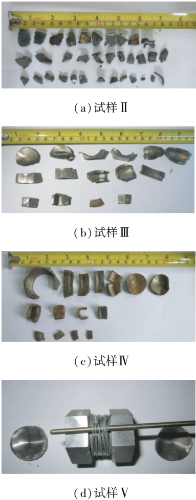
图 4 第二组试样试验后壳体回收情况 Fig.4 Shell recovery after the sample test No. 2
